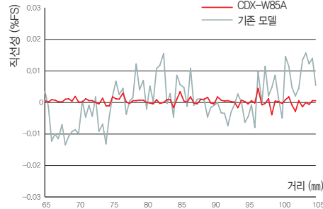
기존 모델보다 [±0.015% F.S.] 고정밀도로 측정 가능한 CDX 시리즈 * 워크 각도 : ± 0° , 확산 모드 측정 조건은 사양을 참조하십시오.
